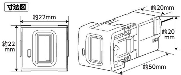
トヨタ車系専用、小型スイッチホール部に専用USBポートを増設
